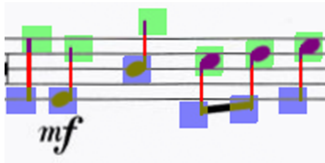
FIGURE 3.3 – Détection des verticales (en rouge) et mise en évidences des zones critiques
